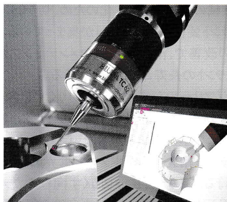
加工後のワークを工作機械上でそのまま測定
